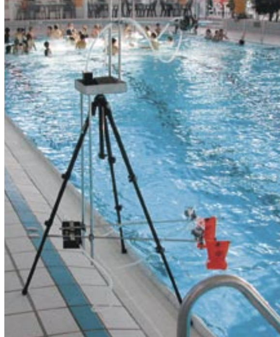
Mit modernen Analyseverfahren untersucht die Unfallkasse in Bädern die Belastung durch Trichloramin.
