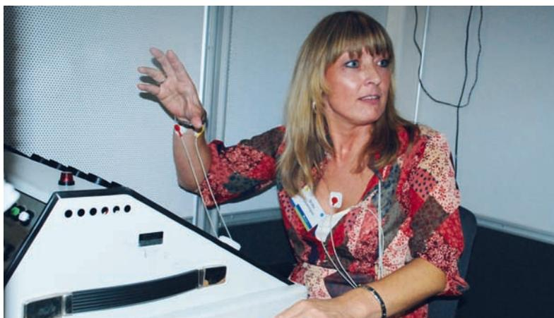
Angebot auf der Fachtagung: In einer sogenannten Stresskammer lässt sich die Konzentrationsfähigkeit einer Person testen.
