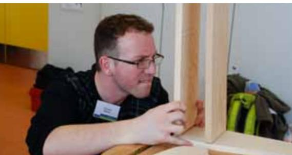
Vor dem Verleimen werden die Holzteile zur Probe zusammengesetzt.
